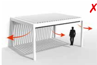
Effet de chaleur avec 1 côté chauffé (format 6 x 4 m)
